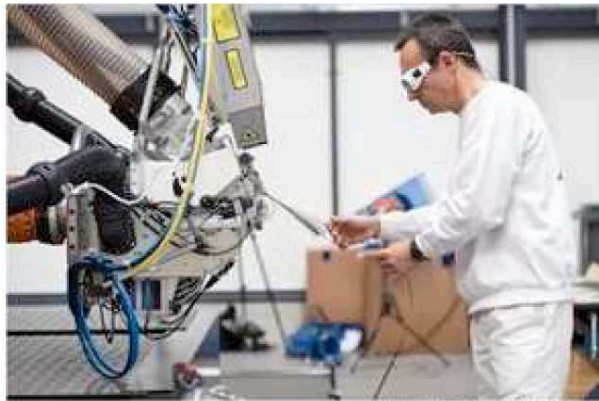
© AIRBUS SAS 2011, Photo de LEONARDO Usines Machine à placement de fibres dernière génération, entièrement dédiée aux thermoplastiques « Flash TP »
