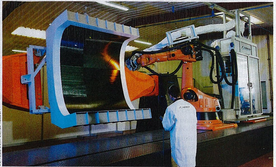
Drapage d'une pièce en moule femelle d'un fuselage d'avion.
